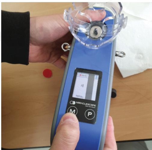
1.注射完毕后，尽快装上专用清洗液瓶，启动清洁模式以清除气缸内的任何异物包括注射液。
